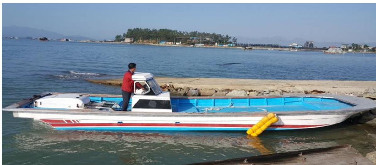
Boat FRP 10,6 x 6,9 m, 3 t, max speed 27 knots
